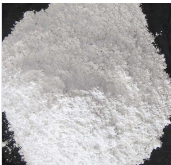
轻质碳酸钙（俗称轻钙），又称沉淀碳酸钙，是将石灰石等原料煅烧生成石灰（主要成分为氧化钙）和二氧化碳，再加水消化石灰生成石灰乳（主要成分为氢氧化钙），然后再通入二氧化碳碳化石灰乳生成碳酸钙沉淀，\*\*\*经脱水、干燥和粉碎而制得。或者先用碳酸钠和氯化钙进行复分解反应生成碳酸钙沉淀，然后经脱水、干燥和粉碎而制得。胶体碳酸钙，又称活化碳酸钙、改性碳酸钙、表面处理碳酸钙、胶质碳酸钙或白艳华，简称活钙，是用表面改性剂对轻质碳酸钙或重钙碳酸钙进行表面改性而制得。由于经表面改性剂改性后的碳酸钙一般都具有补强作用，即所谓的“活性”，所以习惯上把改性碳酸钙都称为活性碳酸钙。蔡甸区油溶性碳酸钙促销碳酸钙是一种无机化合物，化学式为 $\text{CaCO}_3$
